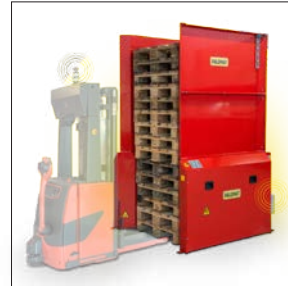
Vorbereitet für AGV 15 Paletten / 500 kg
