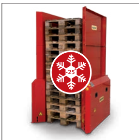
Palettenhandhabung in kalter Umgebung bis zu -25°C. (PALOMAT® Greenline 15 Paletten / 500 kg.)
